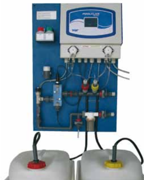
Oben: „pH perfekt“ von Zodiac Pool Deutschland. Das Gerät garantiert den richtigen pH-Wert durch kontinuierliches Einleiten der Korrekturflüssigkeit mittels einer Dosierpumpe. ( www.zodiac-pool-deutschland.de )
